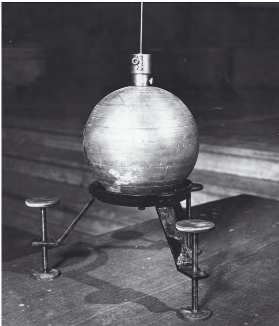
*Dispositivo per il posizionamento del pendolo 'a riposo'.*
